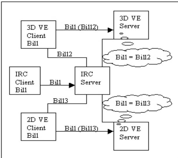
**Figure 2: VE/IRC Name Mapping**
